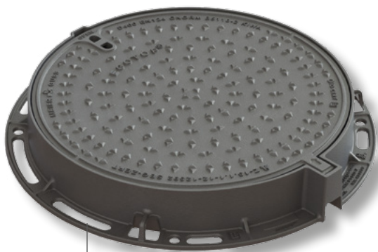
Właz kanałowy klasy D 400, seria ECOTOP®, SFERO, z wkładką tłumiącą, zawiasem i rygłem (904 327)
