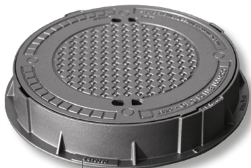
Właz kanałowy klasy D 400 z pokrywą żeliwną, z ramą kołnierзовą o wysokości 140 mm (804 086)
